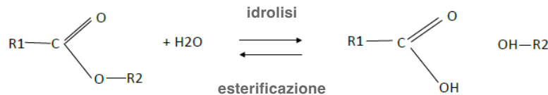
Figura 1: Idrolisi del POE
